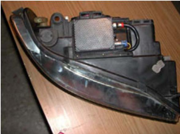
El segundo paso es buscar un sitio para el transformador, se puede colocar debajo de faro o en cualquier parte trasera del faro, los transformadores son impermeables, por lo que no os preocupéis por la humedad, también en los A4 se puede montar en el hueco que llevan de origen para los transformadores, el hueco viene precortado, con ayuda de un cutre podemos desprender estas parte precortadas para pasar los cables.
