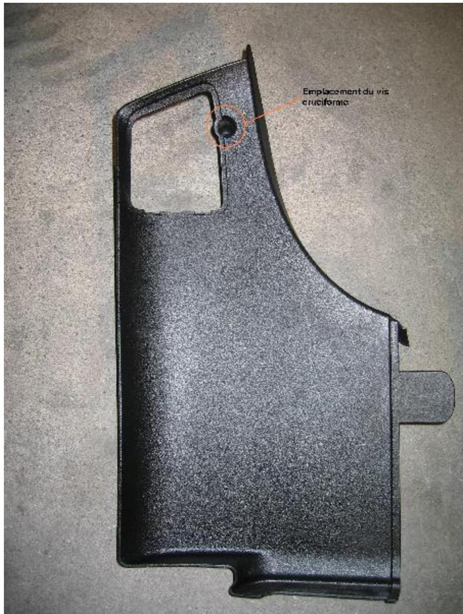
6 – Con la ayuda del gran destornillador plano hacer palanca sobre los plasticos laterales con el fin de quitarlos de sus enclajes. Hay que ir clip por clip para evitar de romperlos.
