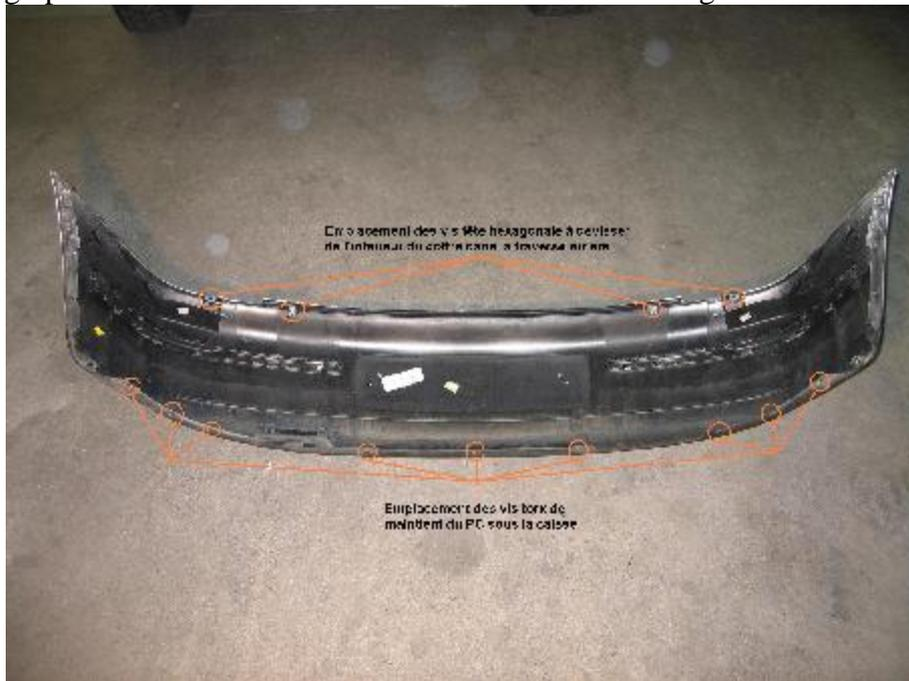
10 – Volver en el maletero. De cada lado debajo de los faros traseros hay 2 tornillos de cabeza exagonal (llave de 10). El acceso no es nada fácil, hay que destornillarlos
