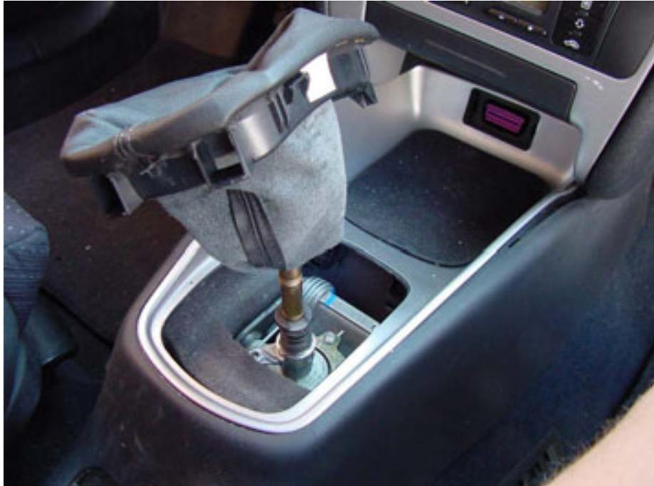
Comenzamos a levantar desde la parte de detrás, a la vez que tiramos un poco, el guarnecido saldrá completo. La parte de la derecha que se ve separa NO debe salir así, el guarnecido es una pieza completa y única, en la foto esta separa por que esta rota.
