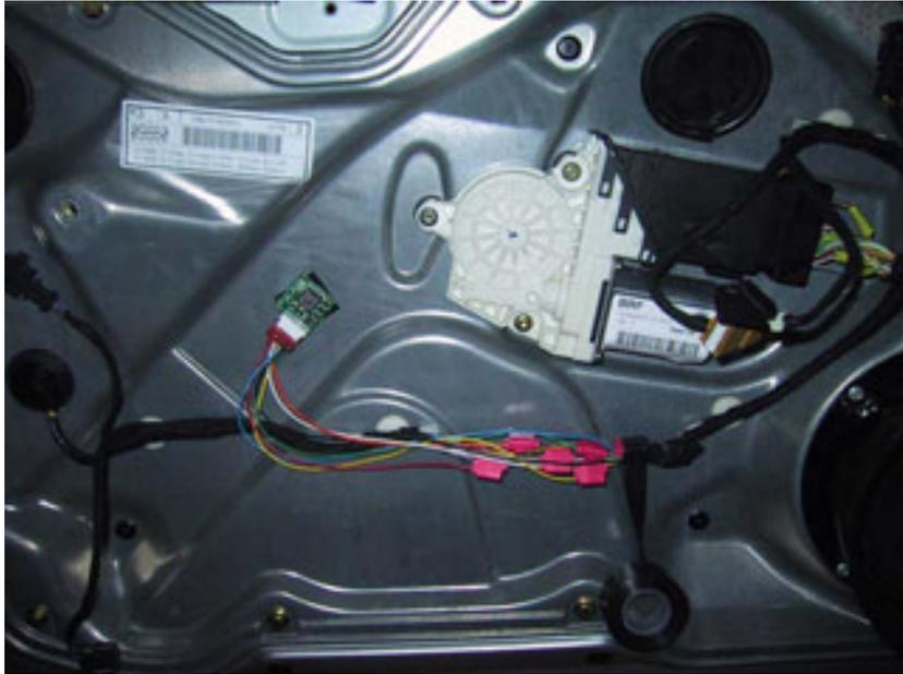
En la foto anterior podéis ver como queda instalado usando los robacorrientes y sin usar caja para el modulo elevavinas.
