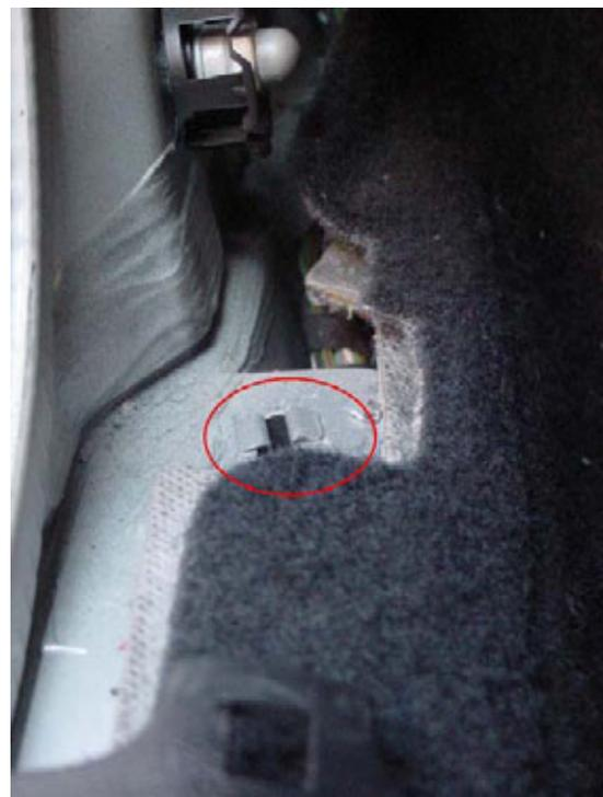
Colocamos de nuevo las grapas y ponemos la pieza en su sitio encajando las dos grapas metálicas , y la de plástico pequeña que permite que quede la pieza alineada junto con el paso de la puerta.
