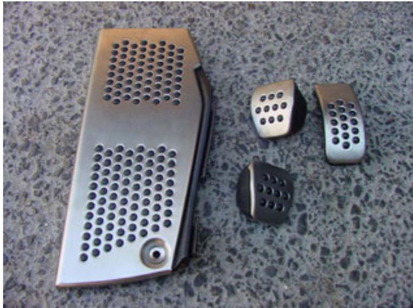
Para que la colocación sea más fácil es necesario tener un destornillador plano y que sea corto, para que pueda acceder entre el suelo y los pedales. También sería necesaria alguna fuente de iluminación y sobre todo un espejo para poder ver la parte inferior de los pedales.
