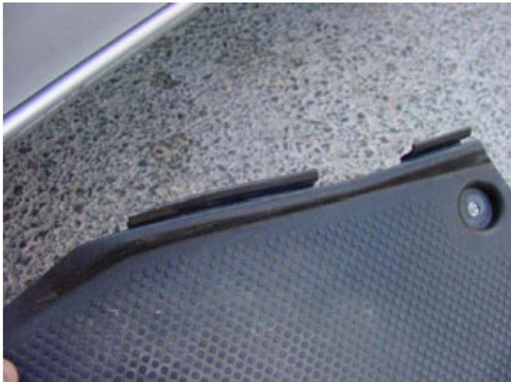
Este carril queda enganchado en el guarnecido de la izquierda al lado de la puerta. Si no quieres muchos problemas y hacerlo fácilmente, quita los dos tornillos de estrella que sujetan el tirador que abre el capo del coche. Al quedar libre esta pieza, puedes tirar hacia arriba del guarnecido en el punto que se marca en rojo.
