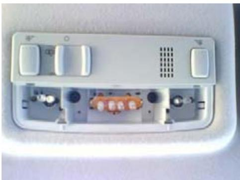
Aspecto de las diferentes luces colocadas en sus correspondientes soportes del plafón del SEAT LEON I
