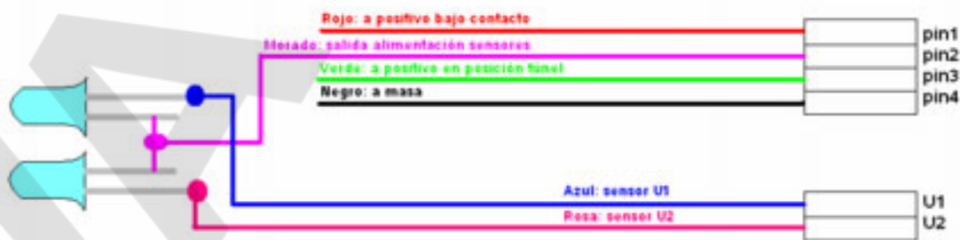
Ilustración 5 - Cableado de alimentación y sensores
